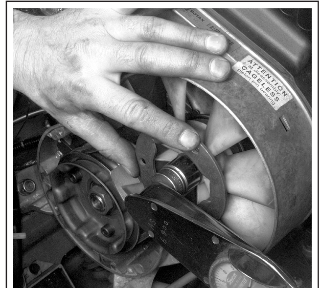
TORQUE FAN NUT USING FAN HOLDER TOOL
