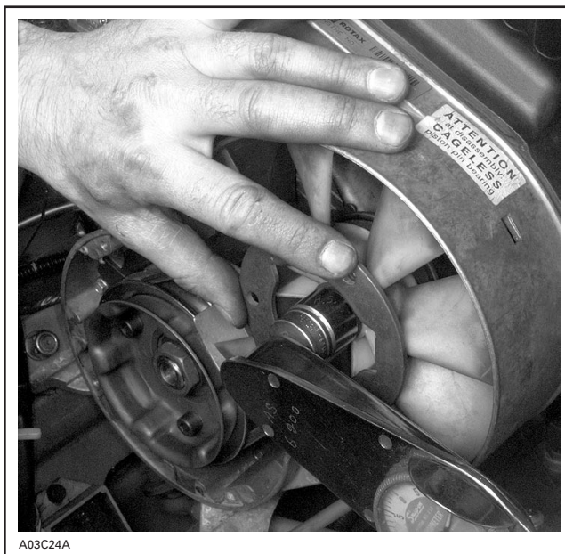
TORQUE FAN NUT USING FAN HOLDER TOOL
