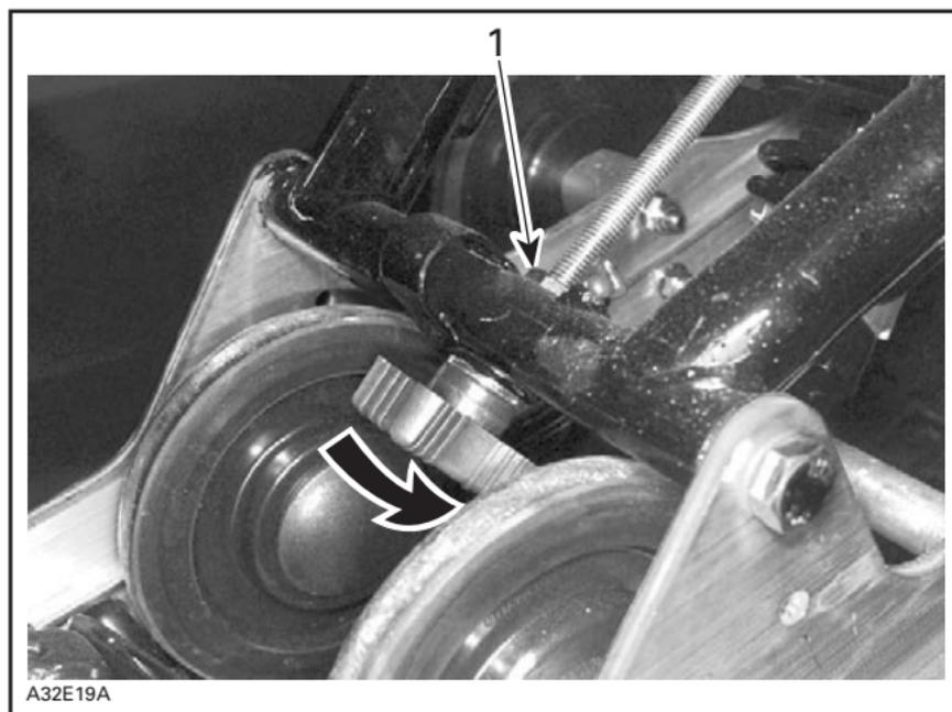
1. Desserrer l'écrou autobloquant, tourner le bouton en conséquence, puis resserrer l'écrou autobloquant
