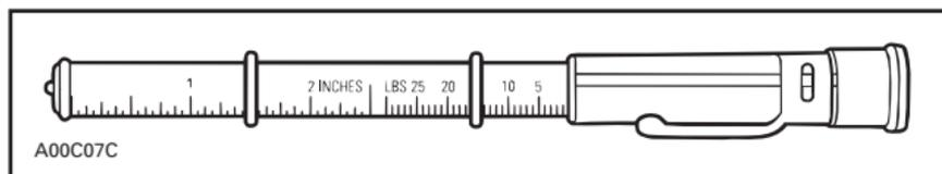
VÉRIFICATEUR DE TENSION POUR COURROIES
