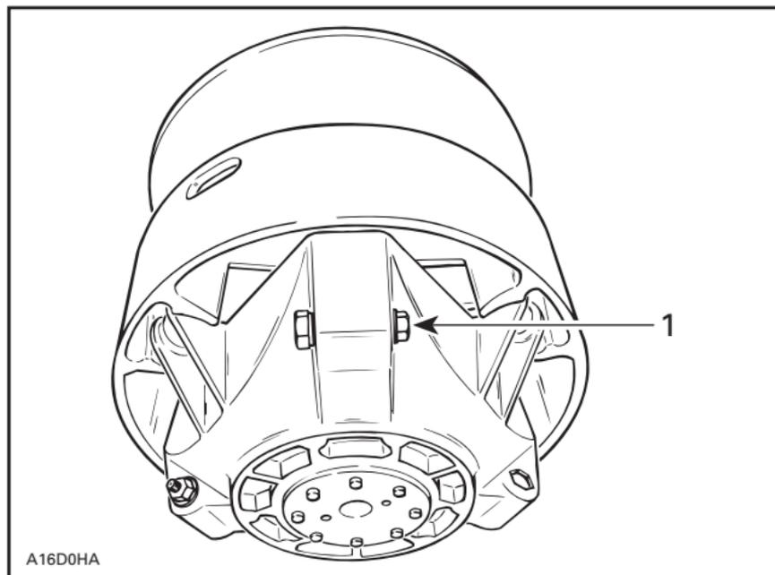
1. Desserrer juste assez pour qu'il soit possible de tourner la vis de calibrage
