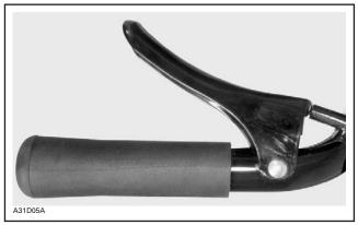
CORRECT BRAKE LEVER POSITION BEFORE STARTING
