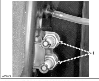
REV SERIES — SPARK PLUG HOLDER ON LEFT HAND SIDE PANEL
