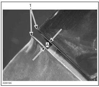
PROPER FIT OF WINDSHIELD VERSUS CONSOLE
