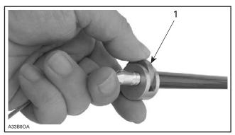
LOCKING DEVICE ON LAST PROBE SECTION END
