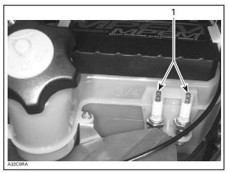
ZX SERIES — SPARK PLUG HOLDER ON INJECTION OIL RESERVOIR
